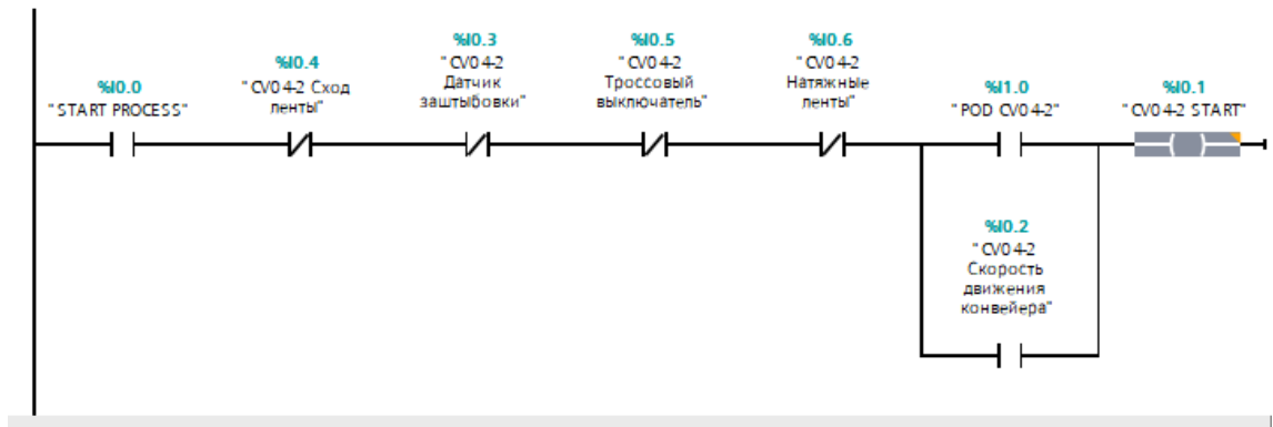
Рисунок 2.28 – Программа запуска первого с конца конвейера на участке измельчения
